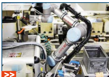
Der elektronische Greifer erkennt verschiedene Schraubengrößen.
